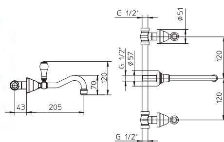
Batteria lavabo incasso a 3 fori senza scarico
