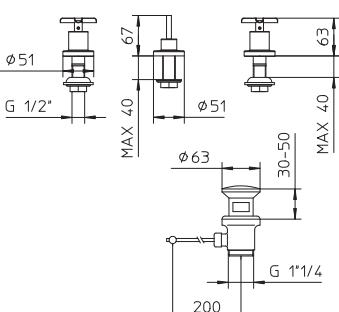
Batteria bidet a tre fori con scarico 1"1/4.
