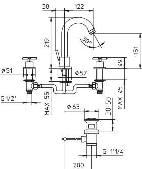
Batteria lavabo a tre fori con bocca girevole e scarico 1"1/4.
