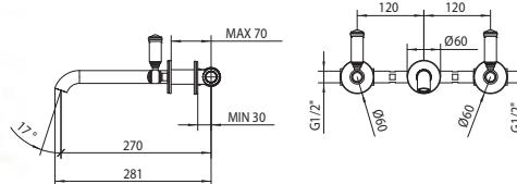
Batteria lavabo incasso a 3 fori senza scarico
