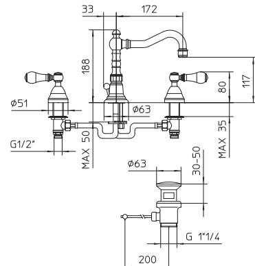
Batteria lavabo a tre fori con bocca girevole e scarico 1"1/4.
