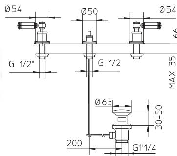
Batteria bidet a tre fori con scarico 1"1/4.
