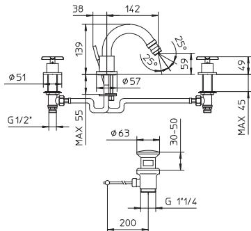
Batteria bidet a tre fori con bocca girevole e scarico 1"1/4.
