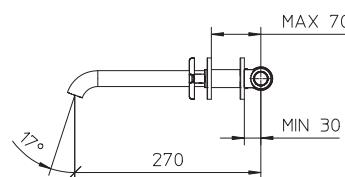
Batteria lavabo incasso a 3 fori senza scarico
