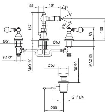
Batteria bidet a tre fori con bocca girevole e scarico 1"1/4.
